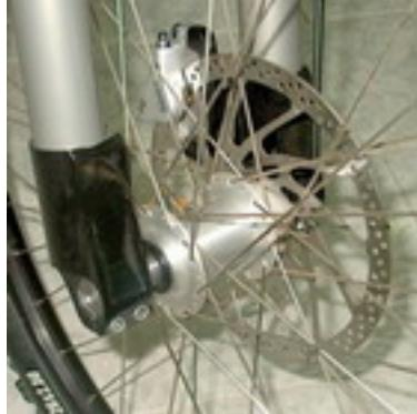
Τα κέντρα των τροχών έχουν υπερμέγεθες σώμα διαμέτρου 40 mm για μεγάλη ακαμψία και αντοχή. Δέχονται δίσκους φρένων
